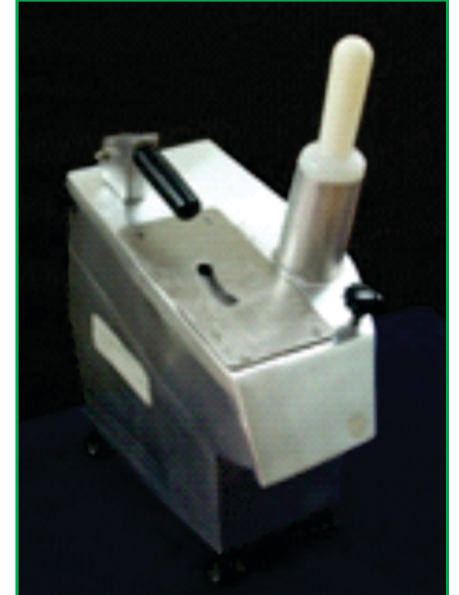
चित्र 5. नारियल का चिप्स बनाने की विद्युतचालित मशीन
