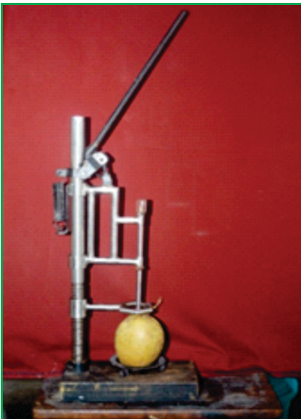
चित्र 1. कोमल नारियल को छेदने व काटने की मशीन
