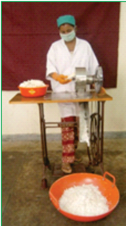
चित्र 6. नारियल का चिप्स बनाने की हस्तचालित मशीन
